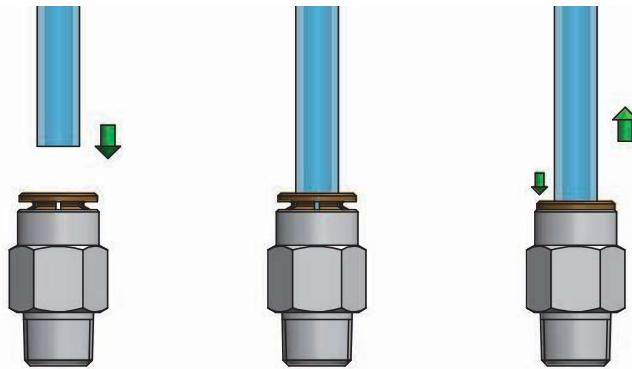
**!** Effettuato il collegamento, assicurarsi che il tubo inserito nel raccordo non sia sottoposto ad alcuna forza di trazione; è necessario inoltre rispettare durante il collegamento del tubo il raggio minimo di curvatura consigliato così come riportato nella sezione tubi di questo catalogo tecnico (vedi pag. 363).
